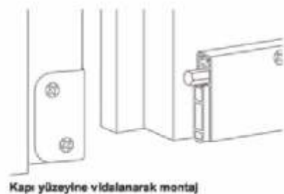
Kapı yüzeyine vidalanarak montaj
